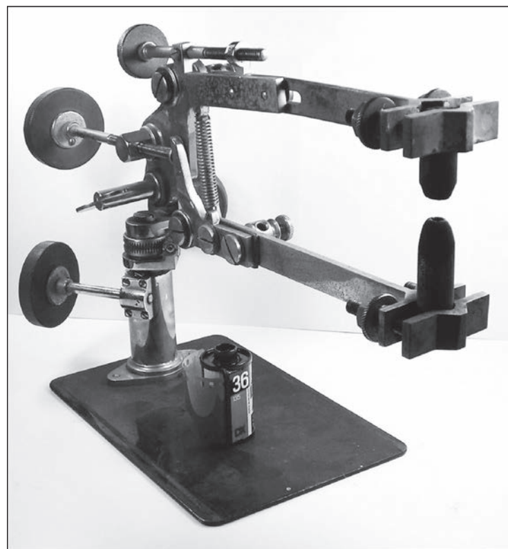
Figure 16 Éclairage à arc de la lanterne présentée ici. Au fur et à mesure de l'usure des charbons, une manette permet de les rapprocher (la bobine de film 24 x 36 mm donne l'échelle). Sur certains systèmes plus élaborés, ceci se fait par un mécanisme à mouvement d'horlogerie. Collection Lucien Gratté.
