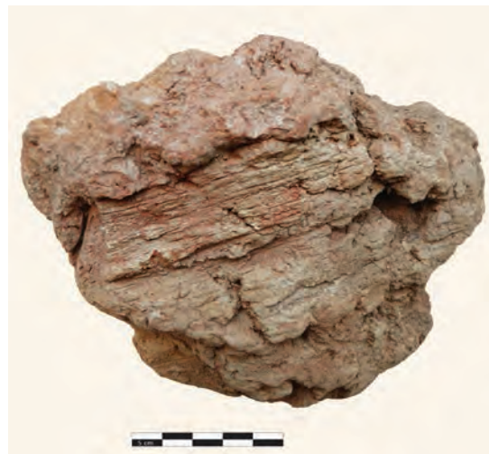
Vue d'une boule cuite avec empreinte d'une armature en bois figée par l'action thermique de l'incendie révélant qu'il s'agit de torchis c'est à dire d'un mélange d'argile et de paille plaqué à l'état plastique sur une armature en bois (© CNRS C.-A. de Chazelles et H. Gazzal)
