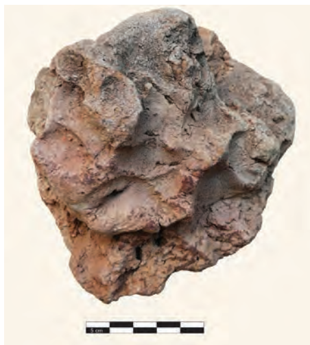
Vue d'une boule de bauge cuite montrant qu'il s'agit du matériau composite (argile et tiges végétales) fabriqué par malaxage avec de l'eau (© CNRS C.-A. de Chazelles et H. Gazzal)
