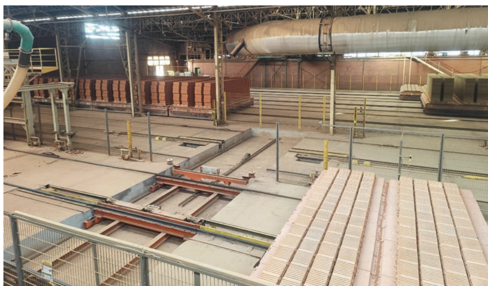
L'espace de séchage et de cuisson des briques
